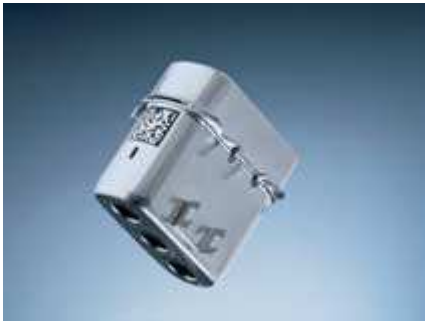
Der Laser findet überall Platz: Höchste Informationsdichte beim 2D-Barcode auf einem elektronischen Bauteil.
