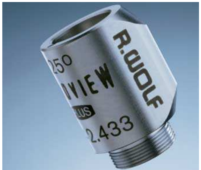
Metalle können durch Anlassen extrem kontrastreich und dauerhaft beschriftet werden.
