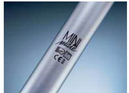
Hoher Kontrast bei unverletzter Oberfläche: Anlassen von Edelstahl.
