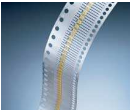
Produktidentifikation auf kleinstem Raum: lasermarkierte Elektronikkomponenten.
