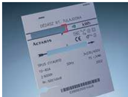
Gerätespezifische Beschriftung: Stromzähler-Frontblende.
